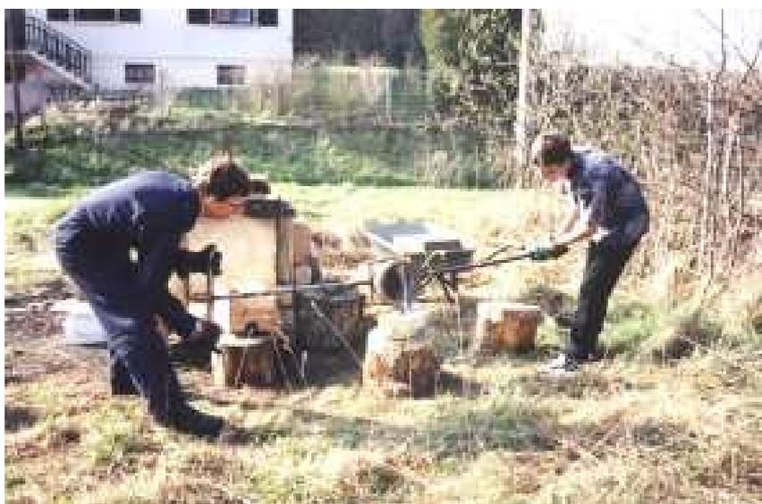
Il arrive aussi que de l'air qui s'est retrouvé prisonnier dans le moule remonte dans les cheminées et fait une sorte de bulle prête à « exploser ». D'où une attention particulière et un contrôle jusqu'à ce que le métal passe de l'état de « Liquidus » à celui de « Solidus ».
